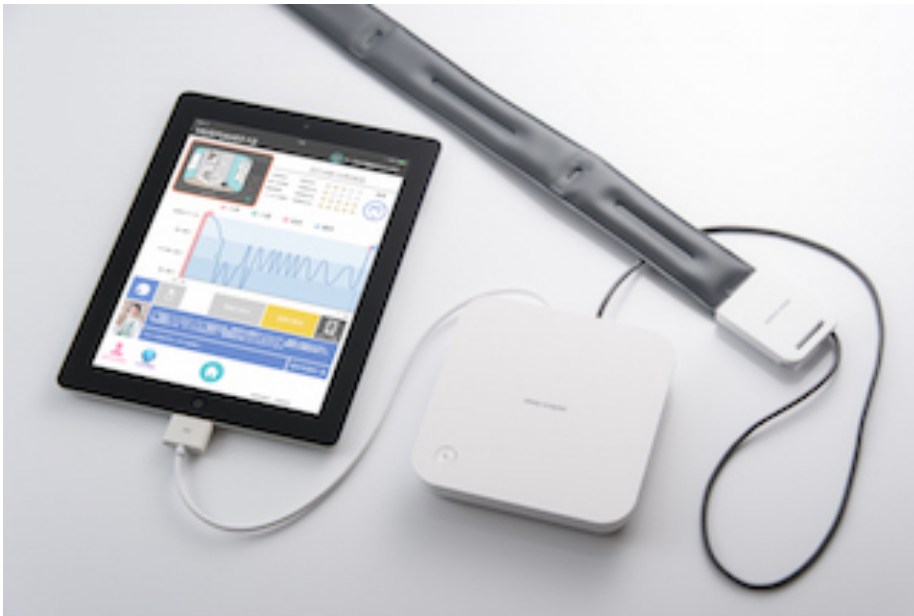
図5 エアマット式睡眠記録装置（写真提供 ASD 株式会社）
