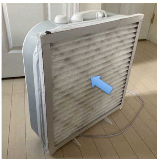
図 1 試作した 1Filter+1Fan 型空気清浄機(1-1 Box) 矢印は空気の流れ (以下同様)
